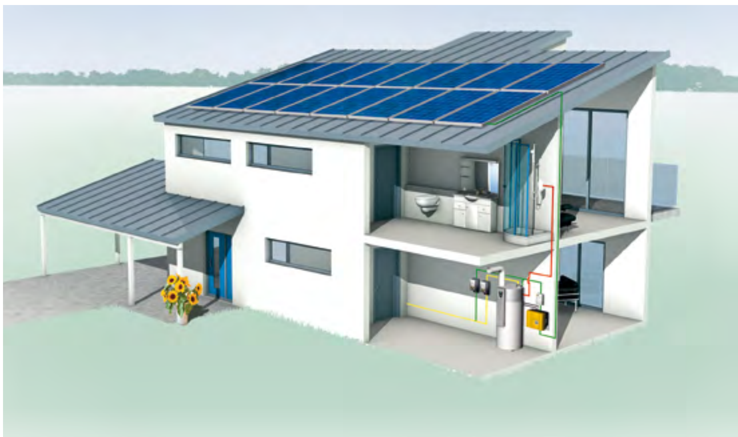
Фотогальваническая энергетическая установка с тепловым насосом
