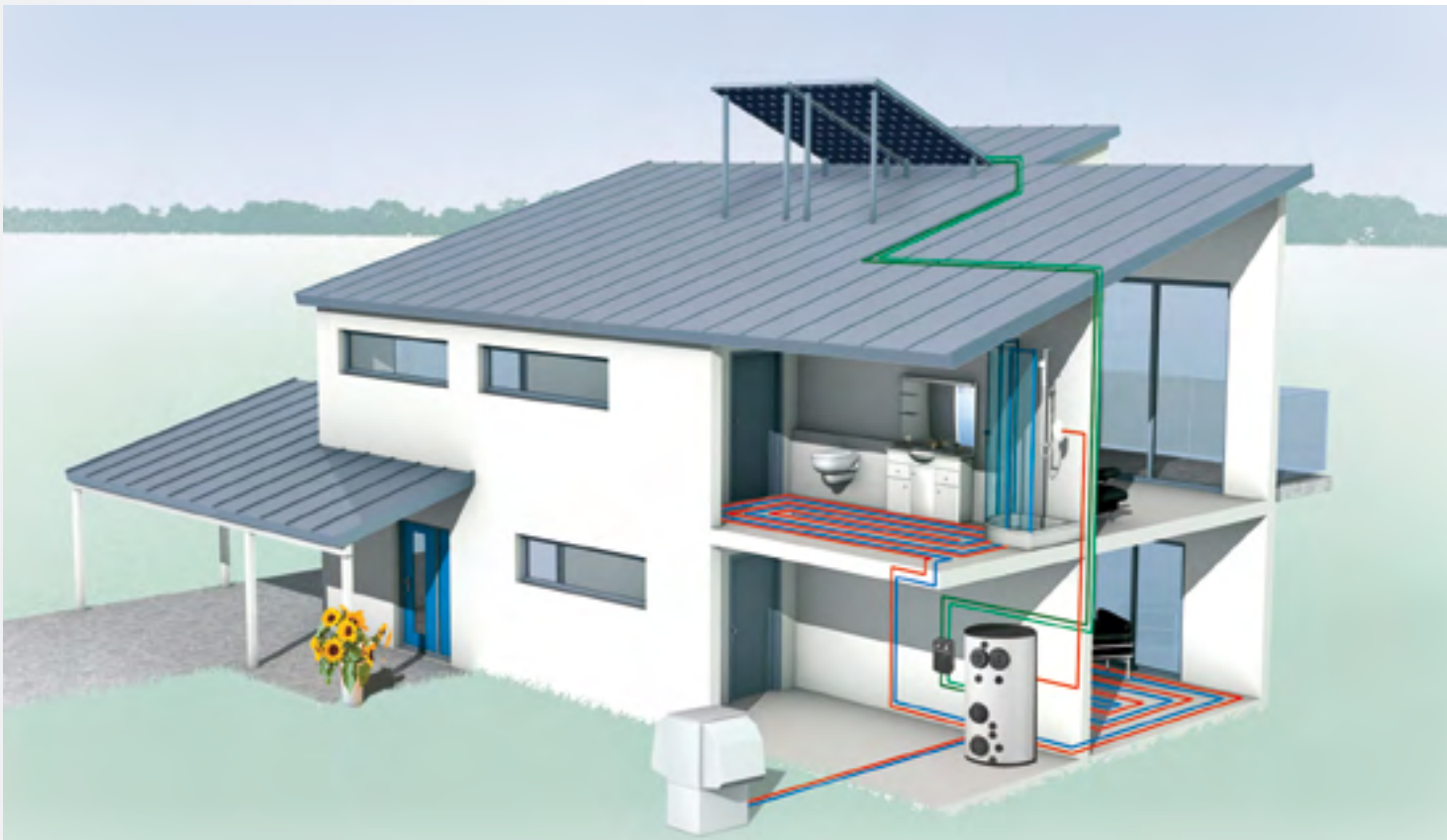
Гелиотермальная установка с тепловым насосом
